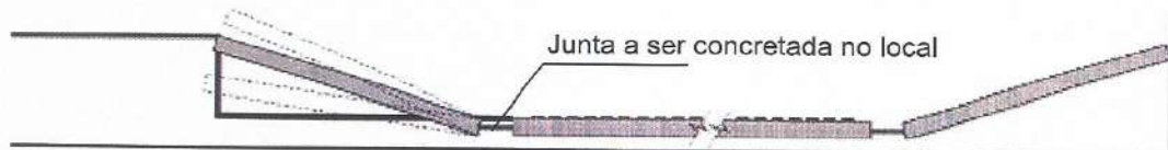
Figura 9 – Conformação da peça pré-fabricada através de dobragem das suas abas nas regiões da armadura sem cobertura - posteriormente estas regiões serão concretadas com um microconcreto de mesmo traço que o da peça.
